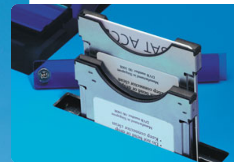
Option: 2x Common Interface (CI) zur Aufnahme aller gängigen CAM-Module.
