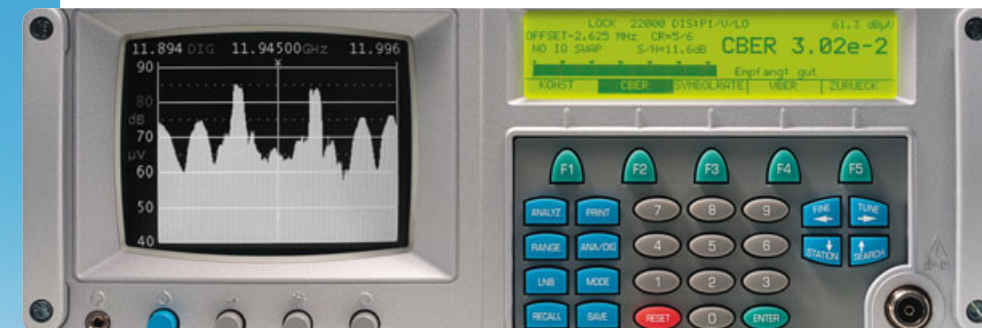
Die hochauflösende s/w-Bildröhre (5,5") für optimale Bildkontrolle. Abbildung: schmalbandiges Spektrum SAT.
